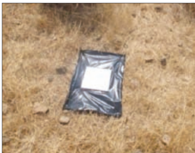
Figura 9 - Esempi di punti d'appoggio pre-segnalati.
