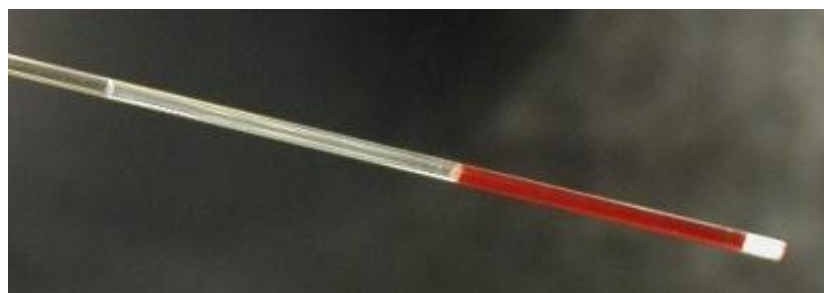
Fig. 21: risultato della centrifugazione del sangue intero in un capillare per microematocrito.
