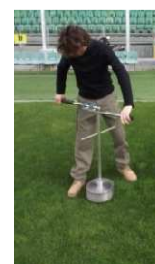
Foto n°6. Replica del torsionometro fedele a quello Canaway_bell, durante i rilievi allo stadio Renzo
