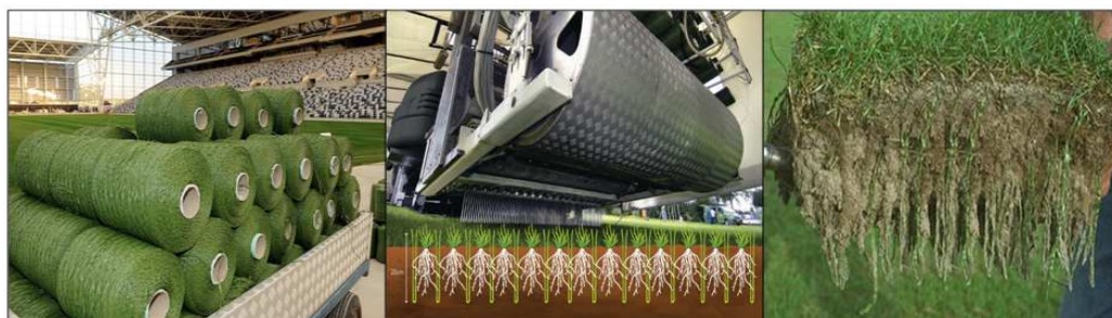
Foto n°1. Tappeto erboso rinforzato, realizzato dalla ditta Desso GrassMaster
