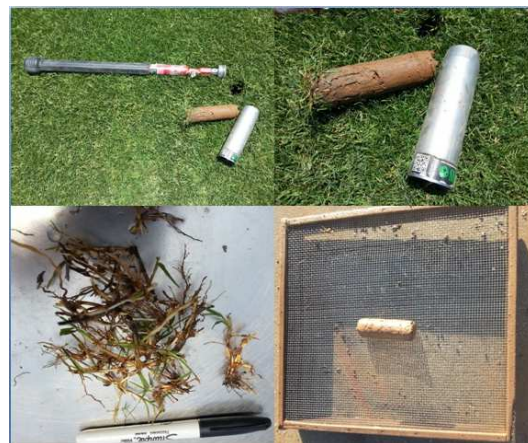
Foto n°15. Operazione di pulitura apparato radicale. In alto a dx e sx carotatore, in basso a sx stoloni e rizomi dopo lavaggio carota di suolo, in basso a destra griglia per pulizia radici
