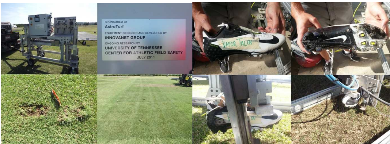
Figura n°12-13 . Tennessee Athletic Field Tester (TAFT) e scarpa Nike Vapor Talon Hyperfuse impiegate per il test
