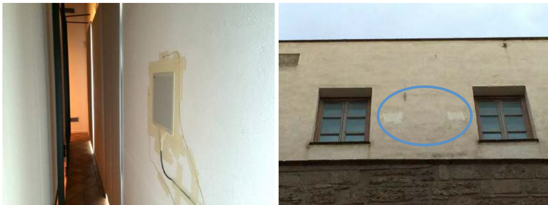
Figure 4.47, 4.48. Punto di misura 10 ( a sinistra ) e posizione dei sensori esterni di temperatura ( a destra ).
