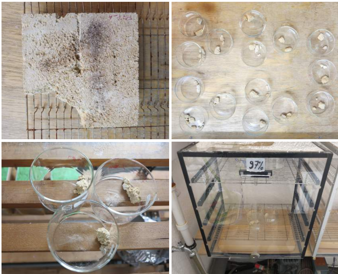
Figure 4.18, 4.19, 4.20, 4.21. In alto : Parte A2 del concio di calcarenite ( a sinistra ), dalla quale sono stati ricavati i campioni per la misura dell'assorbimento igroscopico ( a destra ). In basso : provini esposti a un'umidità relativa del 50% ( a sinistra ) e del 97% ( a destra ).
