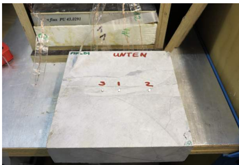
Figura 4.13. Misura della conducibilità termica di un campione di calcare compatto di Billiemi. Si notano i tre punti della faccia inferiore del provino sui quali collocare i sensori e sui quali è già apposta la pasta termica.
