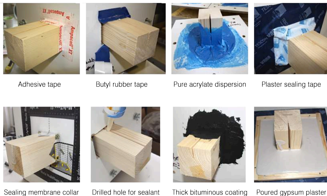
Figura 5.5. Soluzioni per il miglioramento della tenuta all'aria delle teste di trave analizzate da Peper et al. (2014). Immagine rielaborata a partire da quella riportata in Peper et al. (2014).
