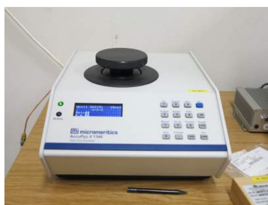
Figure 4.6, 4.7, 4.8. Parti dei conci A, B e C ( in alto, da sinistra a destra ) da cui sono stati prelevati i campioni ( in basso a sinistra ) adoperati per la misura della massa volumica reale con picnometro a elio ( in basso a destra ).
