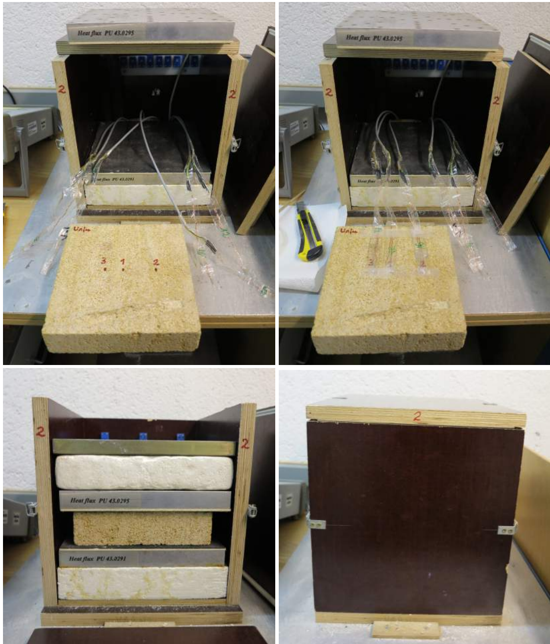
Figure 4.9, 4.10, 4.11, 4.12. Procedimento di misura della conducibilità termica.
