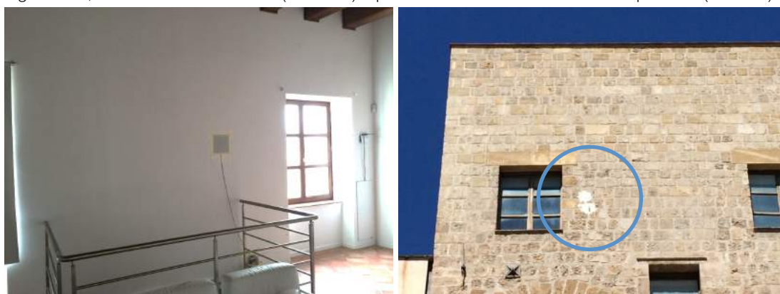
Figure 4.59, 4.60. Punto di misura 16 (a sinistra) e posizione dei sensori esterni di temperatura (a destra).
