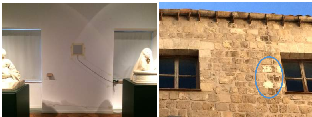
Figure 4.57, 4.58. Punto di misura 15 (a sinistra) e posizione dei sensori esterni di temperatura (a destra).
