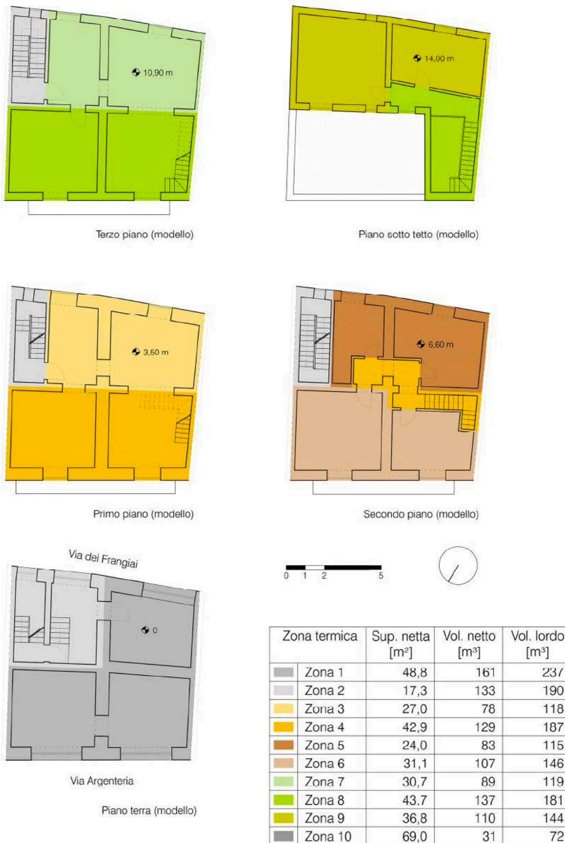
Figura 7.15. Piante semplificate adoperate nella modellazione mediante WUFI Plus del "catoio" di via Argenteria.
