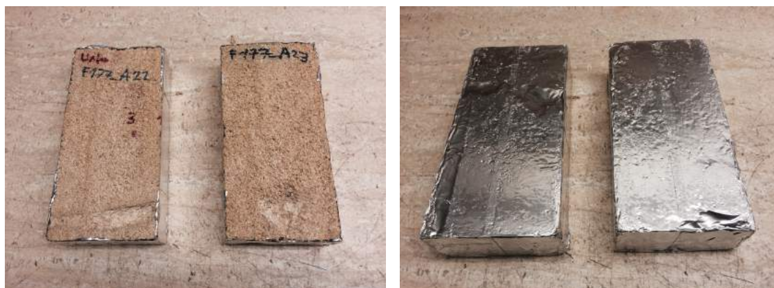
Figure 4.33, 4.34. Campioni della calcarenite A sottoposti alla prova di asciugamento.
