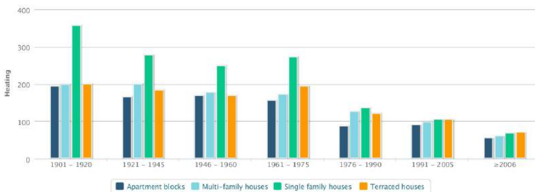
Figura 1.8. Confronto fra i livelli di consumo energetico per il riscaldamento (in kWh/m 2 /anno) nel patrimonio residenziale italiano distinto per epoca di costruzione. Il grafico, che riporta i dati elaborati nell'ambito dei progetti TABULA ed EPISCOPE, è desunto dal Data Hub for the Energy Performance of Buildings predisposto dal BPIE ( http://www.buildingsdata.eu , consultato il 7 gennaio 2016). Buildings Performance Institute Europe ASBL (2012).
