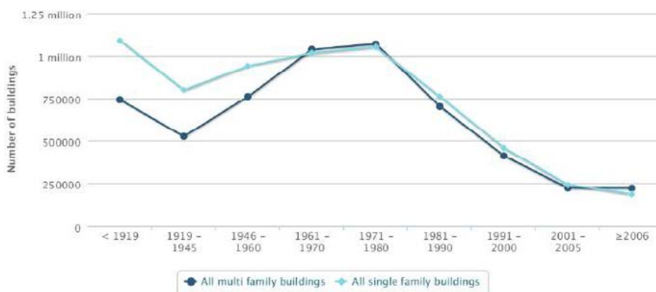
Figura 1.4. Distribuzione del patrimonio residenziale italiano (espresso in numero di edifici) per epoca di costruzione. Il grafico è desunto dal Data Hub for the Energy Performance of Buildings predisposto dal BPIE ( http://www.buildingsdata.eu , consultato il 7 gennaio 2016) e riporta i dati raccolti dal progetto EPISCOPE, provenienti dal censimento ISTAT del 2011. Buildings Performance Institute Europe ASBL (2012).
