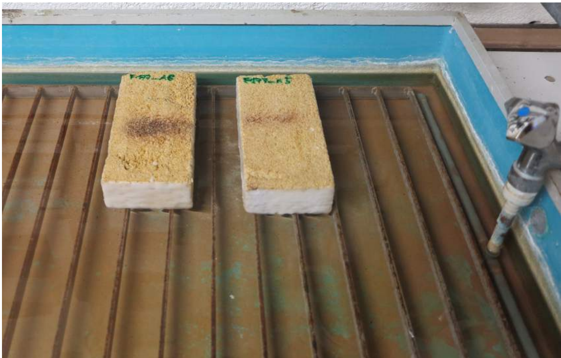
Figura 4.16. Misura del coefficiente di assorbimento d'acqua per azione capillare.
