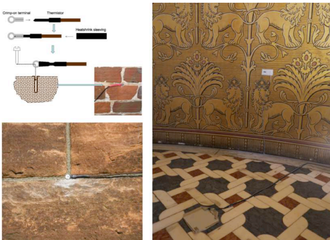
Figura 3.2 (a sinistra). Connessione meccanica di un sensore di temperatura superficiale al paramento esterno di una struttura muraria (Baker, 2011).
