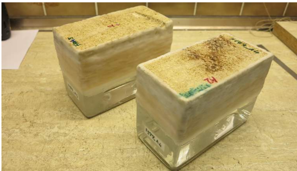
Figura 4.15. Provini preparati secondo il metodo a recipiente umido ( wet-cup ) per la misura del coefficiente di diffusione del vapore.
