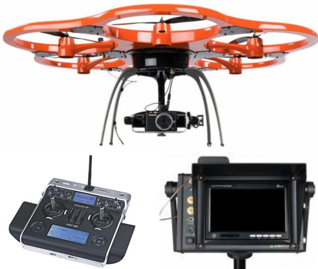
Figura 42 – Micro-drone Aibotix X6 (sopra), radiocomando dotato di stazione ricevente della telemetria (in basso a sinistra) e display (in basso a destra).
