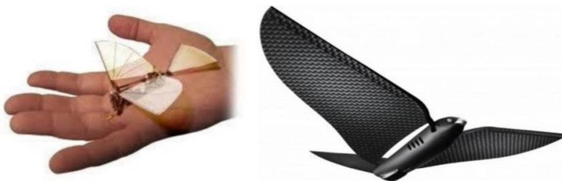
Figura 27 – Esempi di due droni ad ala battente: a sinistra uno simile ad un insetto, a destra uno simile ad un uccello (Negrello, 2012).
