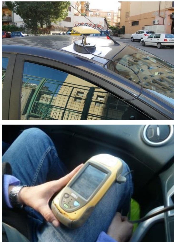
Figura 43 – GPS di tipo differenziale (Topcon GRS-1) installato sul veicolo sonda: sopra l'antenna posizionata sul tetto della macchina, sotto il dispositivo palmare ricevente.
