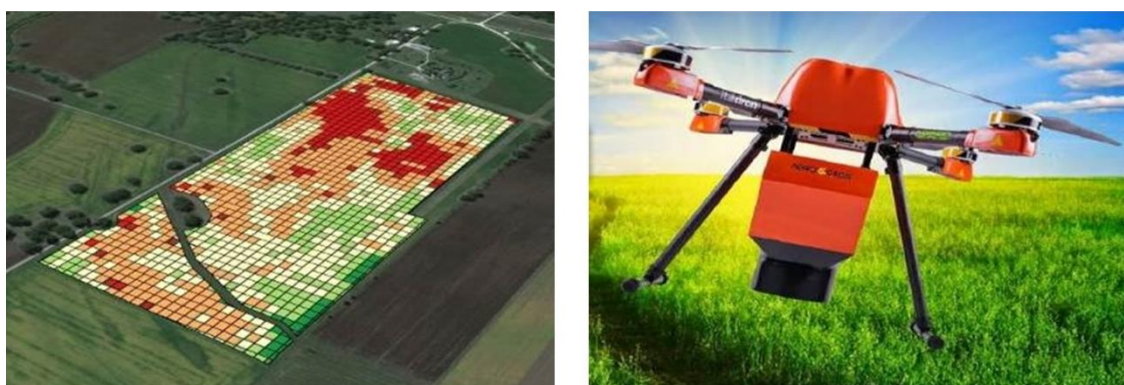
Figura 38 – Sulla sinistra una mappa tematica di una porzione di un vigneto ricavata a partire dall'analisi della radiazione elettromagnetica riflessa delle piante; a destra, invece, è riportato un SAPR utilizzato nella lotta biologica ai parassiti sui campi di mais tramite il rilascio di piccole capsule di cellulosa contenenti le uova di un insetto che contrasta la loro diffusione.
