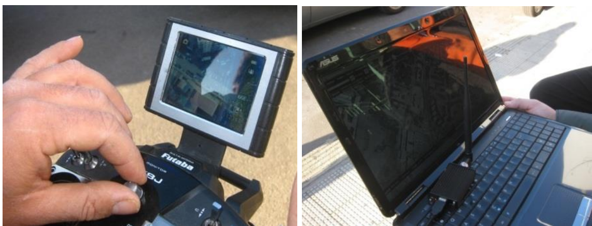
Figura 41 – radiocomando con display integrato (parte sinistra) e stazione di controllo a terra (destra) del micro-drone airvision nt4-contras.
