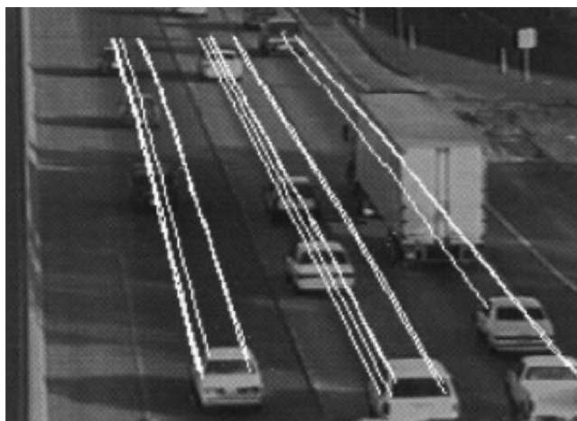
Figura 15 – Tracce delle feature individuate di tre veicoli individuati da Coifman et al. (1998).
