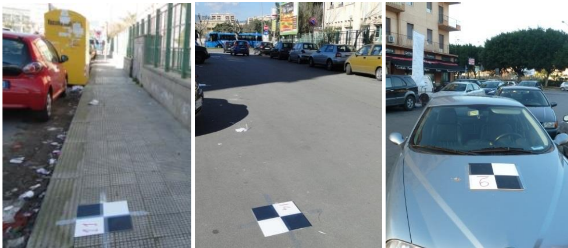
Fig. 44 - Alcuni GCP posizionati per semplificare le successive fasi di elaborazione: a sinistra quello sul cofano del veicolo sonda, al centro ed a destra due messi a terra.
