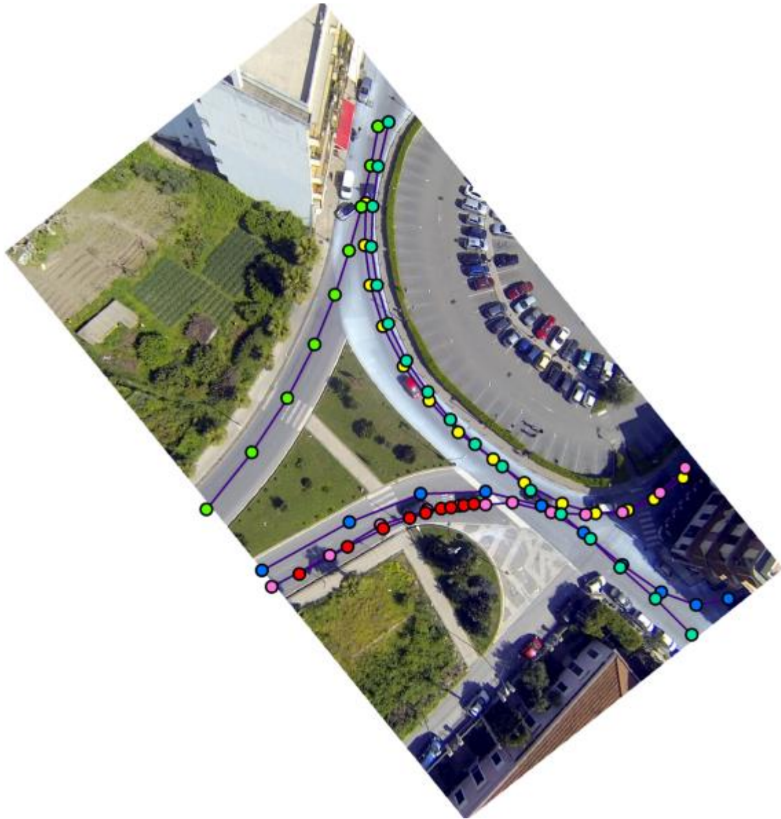
Figura 56 - Tracciamento in ambiente GIS delle traiettorie di dei veicoli utilizzando dei frame precedentemente georiferiti (WGS 84 / UTM zone 33N).
