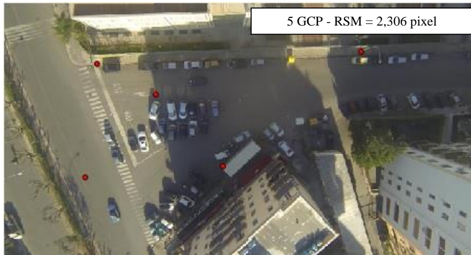
Fig. 46. Visualizzazione dei punti di controllo (GCP) utilizzati ed indicazione dell'accuratezza complessiva (RSM) per la georeferenziazione di un frame campione: 5 GCP utilizzati.
