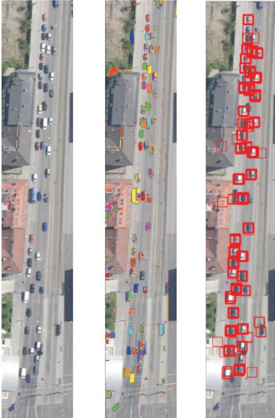
Figura 10 – Fotogramma aereo acquisito in Germania (Monaco) da Tuermer et al. nel 2010 in cui vengono visualizzati a sinistra il fotogramma originale, al centro uno step intermedio di riconoscimento dei singoli veicoli e, a destra, i veicoli riconosciuti.
