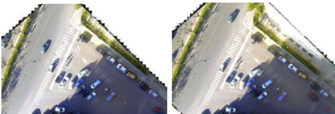
Figura 55 (a) - Tracciamento in ambiente GIS del veicolo sonda (in particolare del punto di controllo posizionato sul cofano anteriore) effettuato attraverso l'utilizzo di 10 frame georiferiti
