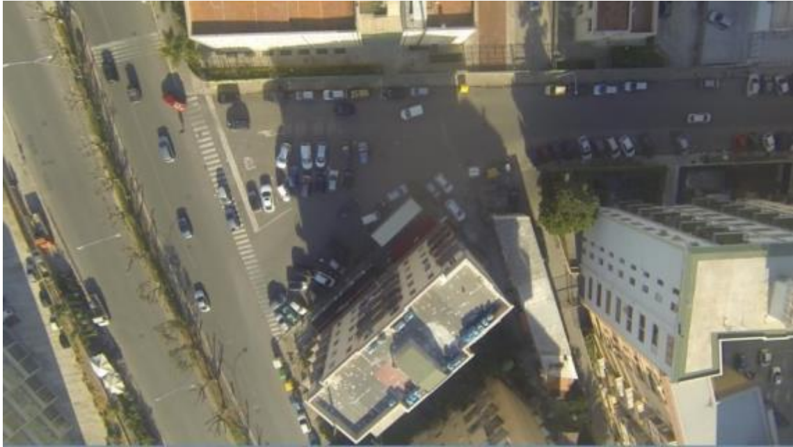
Figura 52. Scena inquadrata dal SAPR in volo ad una quota di circa 70 m relativa la seconda applicazione sperimentale condotta a Palermo in prossimità dell'intersezione a raso non semaforizzata tra la via Ugo Solarino e la via Ernesto Basile.
