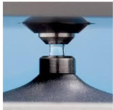
da uno spettrofotometro. Lo strumento viene controllato da un software la cui interfaccia grafica restituisce per ciascun campione la curva di assorbimento e la concentrazione espressa in ng/μl. Lo strumento permette di misurare l'assorbanza (A) a 260 nm, lunghezza d'onda di
