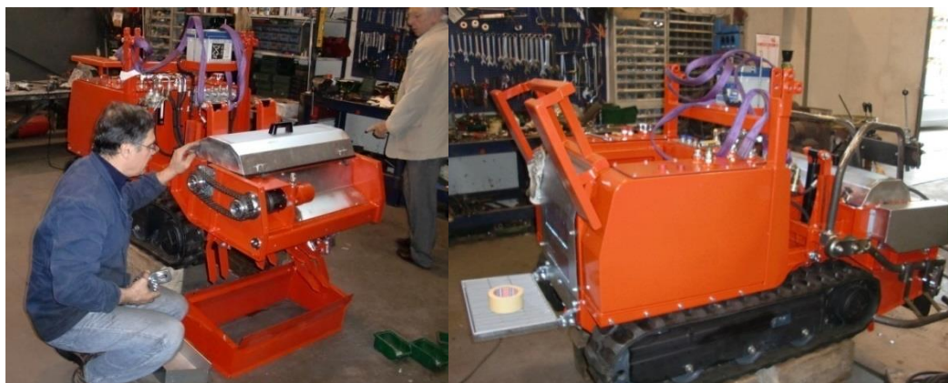
Figura 7 – L'avanzamento dei lavori per la realizzazione della motovangatrice Agrotec
