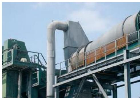
Fig. 4.8 - Impianto di mescolamento del bitume con gli inerti [1].
