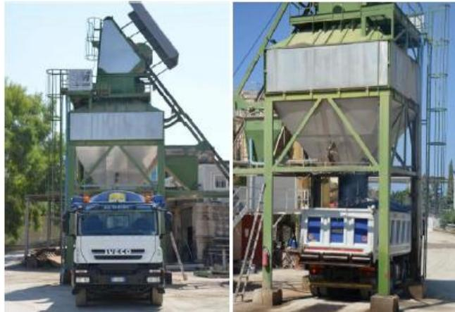
Fig. 4.10 - A sinistra: Torre di confezionamento; a destra: scarico del bitume in automezzo [2].
