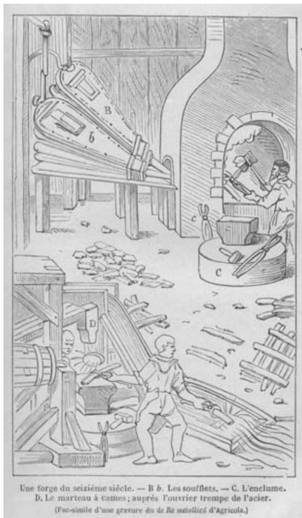
Fig. 1.2 - Con l'adozione dei primi sistemi di ventilazione artificiale con mantici si ottiene un aumento della temperatura dei forni fino a 1150 °C. (da J. Garnier)
