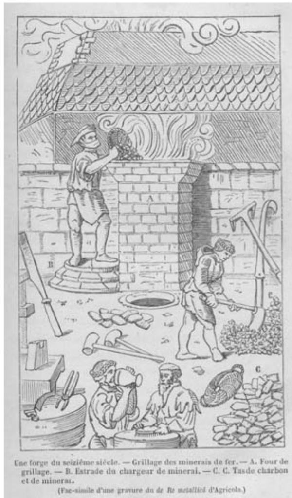
Fig. 1.1 - La temperatura raggiungibile con il carbone di legna non permetteva di giungere alla fusione dei minerali di ferro (ematite). Dal minerale con questo sistema si otteneva una massa tenera e spugnosa. (da J. Garnier)
