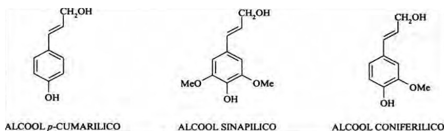
Figure 2.2.11. Unità monomeriche maggiormente presenti della lignina - alcool p-cumarico - alcool coniferico - alcool sinapilico.
