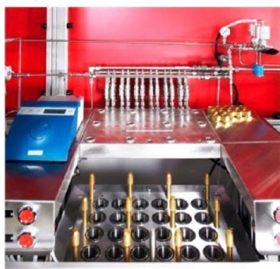
Figura 4-3. Fotografia del reattore high throughput con il particolare del blocco con 24 alloggiamenti/reattore (in basso).
