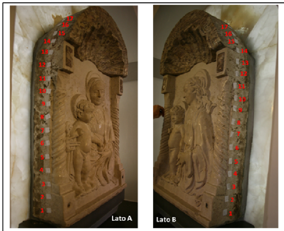
Fig. 4. Posizionamento dei 34 punti di misura per l'acquisizione dei segnali US.
