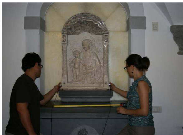
Fig. 2 Posizionamento delle sonde per l'acquisizione dei segnali US sul bassorilievo.
