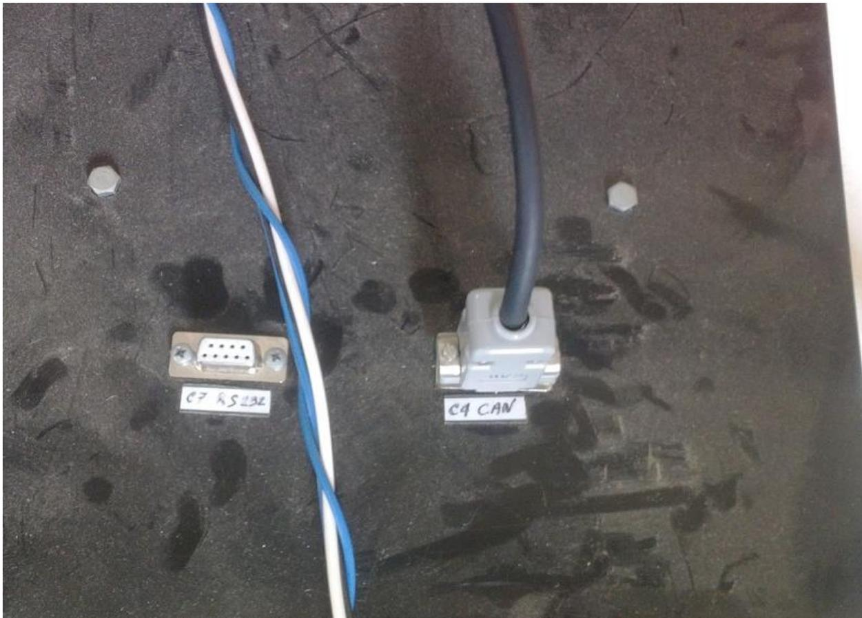
Figura 7. Particolare delle porte di comunicazione.
