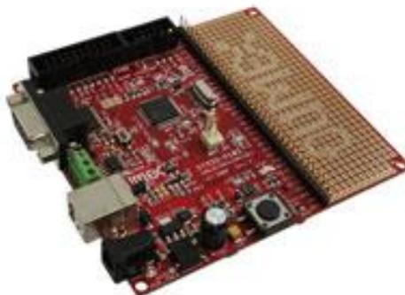
Figura 9. Circuito Olimex per l'interfaccia BMS-dispositivo.
