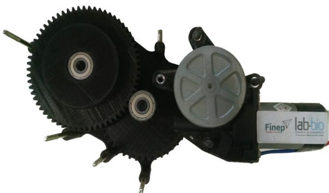
Figura 60 – Caixa de redução acoplada ao motor do cotovelo
