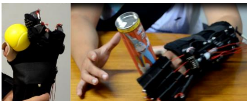
Figura 90 – Abertura dos dedos preensão esférica e cilíndrica
