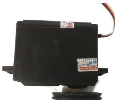
Figura 58 – Servomotor responsável pela movimentação dos dedos
