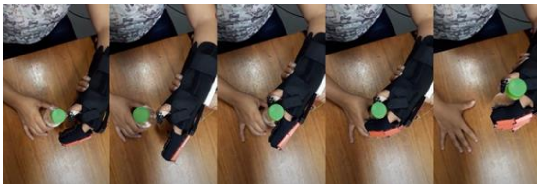
Figura 88 – Abertura dos dedos com órtese robótica preensão palmar
