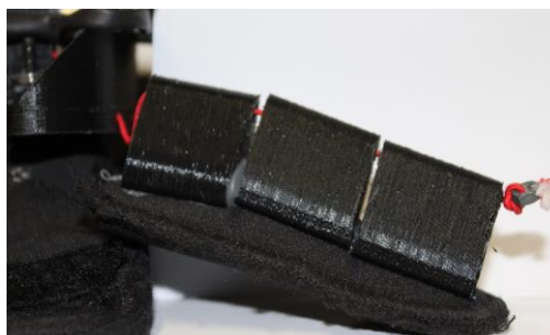
Figura 77 – Falange artificial com altura elevada junto ao metacarpo artificial
