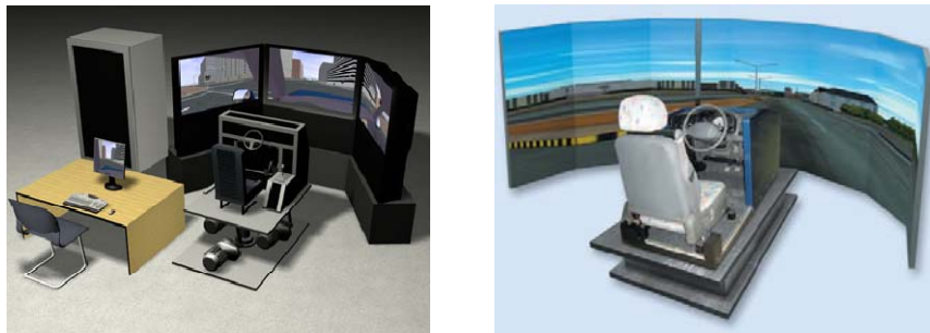
Figura 2.15 – Due esempi di riproduzione dell'ambiente circostante mediante utilizzo di 3 schermi e schermi cilindrici.
