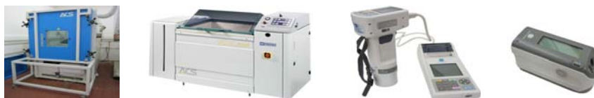
Figura 1. Da sinistra, la camera climatica, la camera a nebbia salina, il colorimetro e lo spettrofotometro
