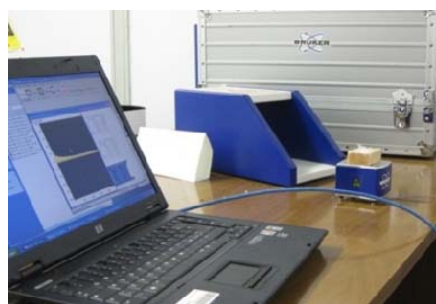
Figura 2. Spettrometro NMR unilaterale (Single-Sided NMR), prodotto dalla Bruker
