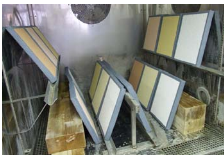
Figura 5. L'interno della camera climatica con i campioni di intonaco
