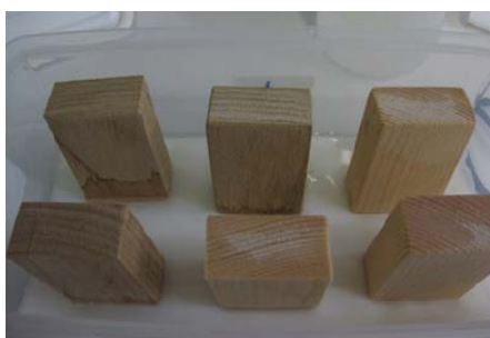
Figura 1. Bagnamento dei campioni per contatto con fogli di carta assorbente imbevuti periodicamente di acqua distillata
