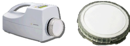
Figura 2. Sistema di campionamento aerobiologico: Air Port MD8 Sartorius (sin.) e filtri sterili in gelatina (dex.) solubili in soluzione acquosa.
