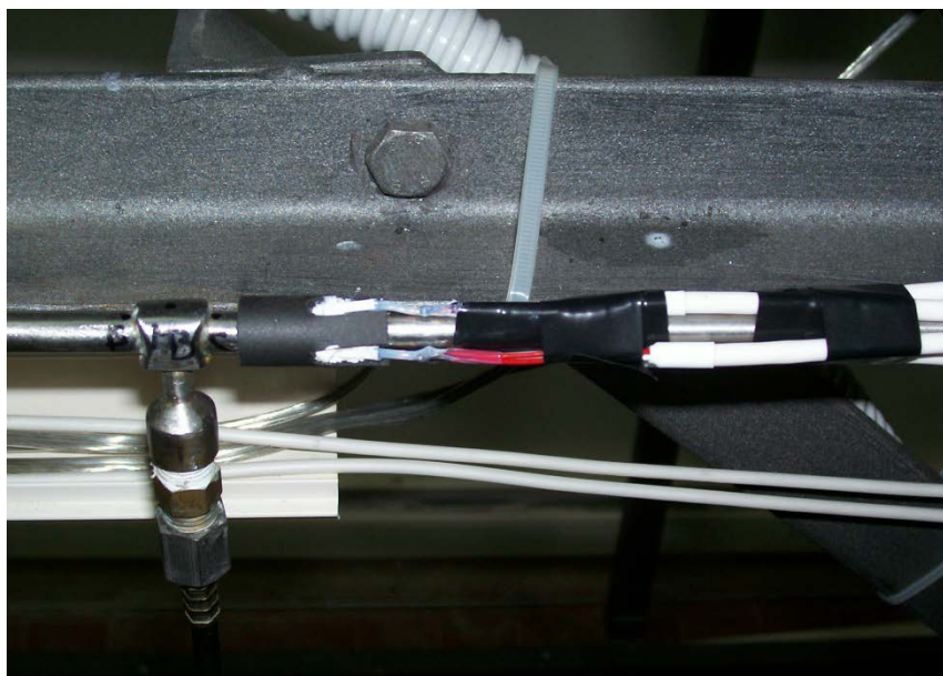
Figura 4.53 Fase intermedia di posizionamento delle termoresistenze nella sezione M.
