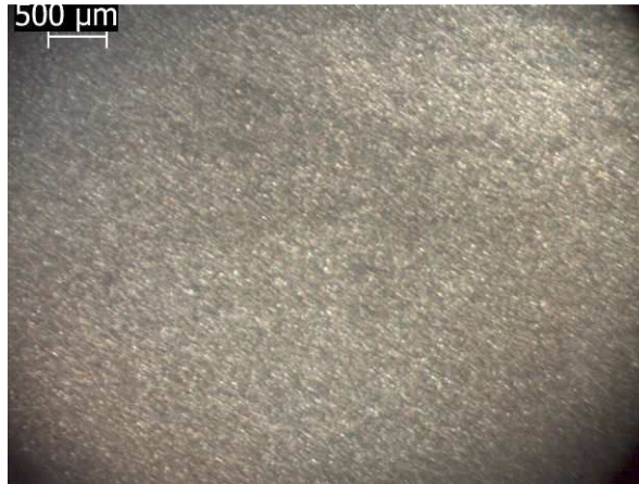
Figura 4.3-8 - Deposito uniforme di 10 µm di stagno galvanico su Cr+Cu sottoposti a processo di ossidazione.
