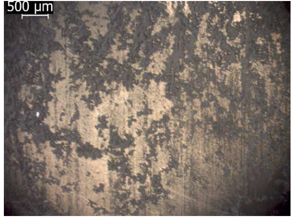
Figura 4.3-7 - Accrescimento galvanico di stagno su cromo ossidato: il cromo non viene dissolto. Sono presenti tracce di deposito.
