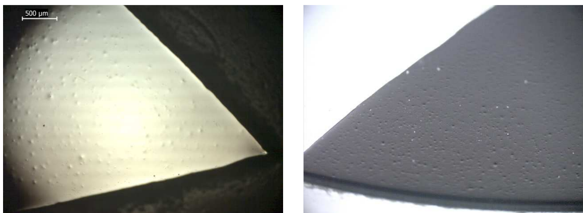
Figura 4.4-3 - Effetto "buccia d'arancia" ottenuto utilizzando solo allumina da 9 \mu\text{m} e SF1.
