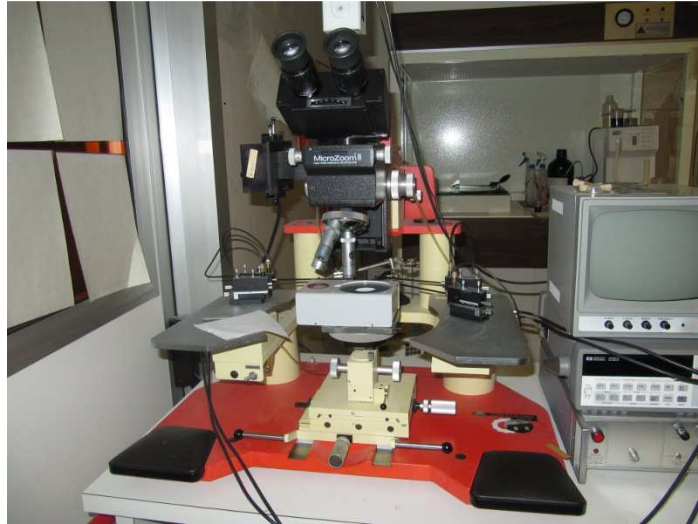
Figura 4.8-3 - Probe station; con opportune modifiche è stata utilizzata per effettuare la brasatura flip-chip.
