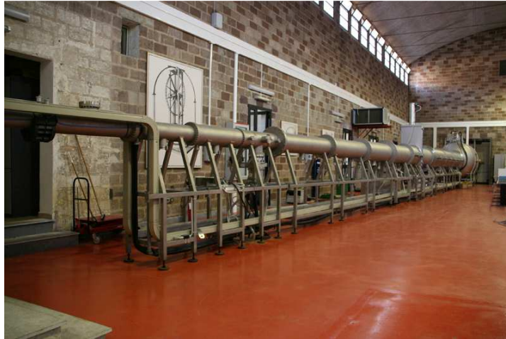
Figura 6.2-1 - Beam-line per la collimazione di raggi X usata nel laboratorio XACT per la calibrazione di strumenti e ottiche.
