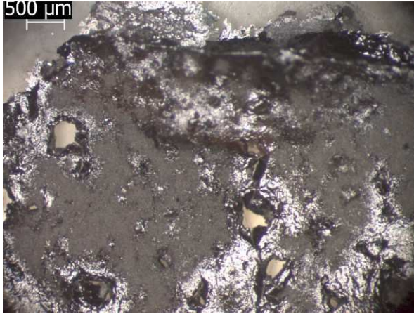
Figura 4.3-6 - Accrescimento galvanico di stagno sul cromo. Il cromo viene dissolto e il deposito è inconsistente.
