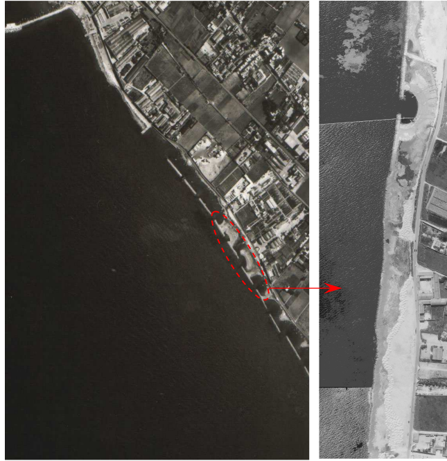
Figura 7.2 - A sinistra particolare dell'immagine aerea acquisita dal volo 1989, dove è visibile la barriera frangiflutti prima delle operazioni di colmata. A destra immagine aerea relativa al volo 2005 con la barriera frangiflutti durante la colmata.
