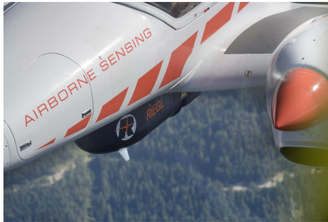
Figura 5.2 - Laser scanner montato su un velivolo leggero.
