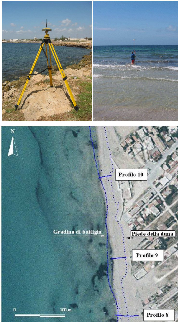
Figura 7.21 - In alto a destra il Master posizionato sul promontorio di Torre Sibilliana. In alto a sinistra un momento del rilievo del profilo della spiaggia. In basso i punti acquisiti per la ricostruzione della linea del gradino di battigia, della linea del piede della duna e dei profili.
