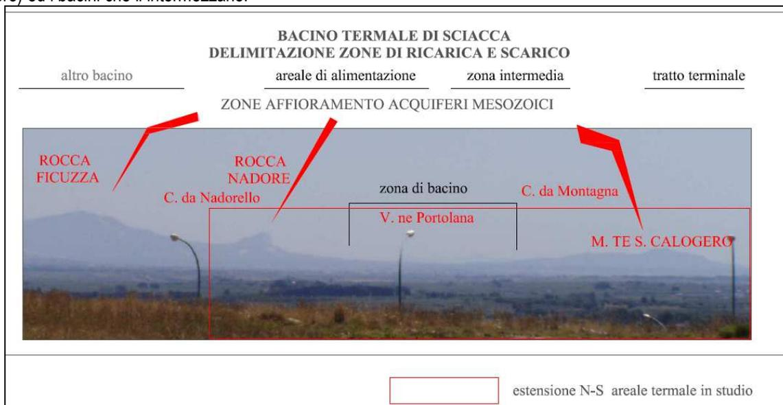
Fig. 18; delimitazione longitudinale delle idrostrutture che costituiscono il bacino termale di Sciacca
