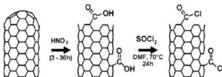
**Fig. 2.1** Ossidazione e successiva sostituzione nucleofila dei gruppi carbossilici di un CNT [2]
