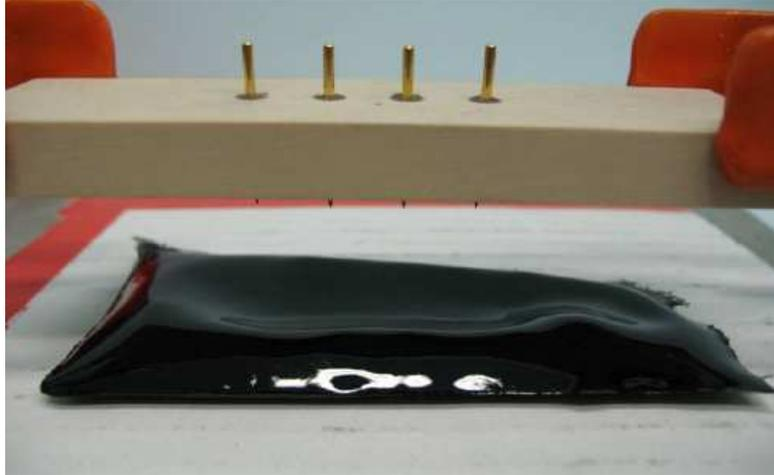
**Fig. 3.9** Cella quadripolare utilizzata per i test di conducibilità
