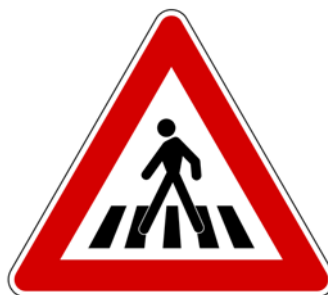
Figura 2.15 – "Attraversamento Pedonale" (segnale di pericolo)
