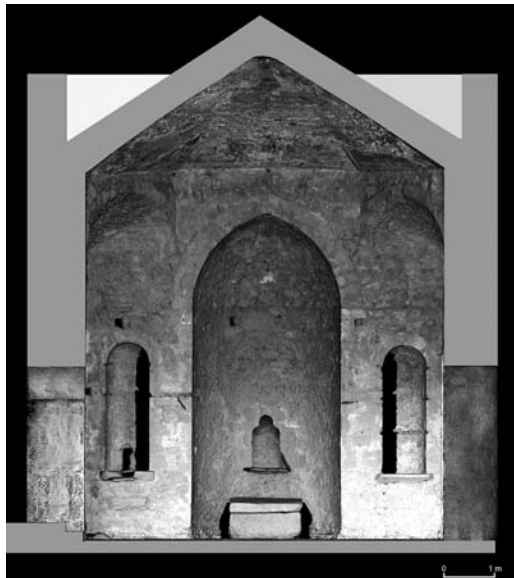
Figura 11 Capilla en el castillo de Montalbano Elicona, corte transversal, vista ortográfica de la nube de puntos (escaneado laser 3D realizado con escáner Leica HDS 7000; autor Mirco Cannella 2013)
