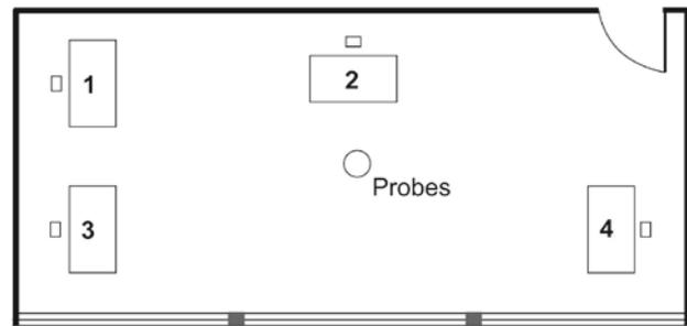
Nella figura 2 è riportata una pianta con schema concettuale della disposizione delle postazioni segnate con i numeri da 1 a 4, e del posizionamento del multiacquisitore e delle sonde per la misurazione delle grandezze termoigrometriche durante il test. Gli altri arredi presenti non sono stati indicati.
