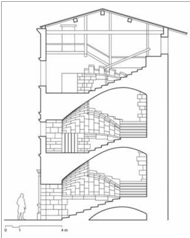
3. Toulouse. Escalera de los archivos del Capitole (según Zaragoza, Calvo y Natividad, con bóvedas continuas por igual).
