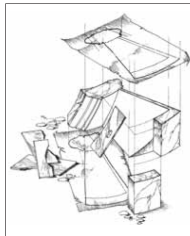
6. Caracol de Mallorca, labra del peldaño. Obsérvese cómo debe colocarse la plantilla del peldaño para lograr la rotación de las molduras (dibujo del autor).
