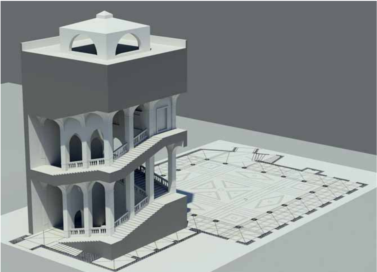
2. Palermo. Palazzo Reale, scalone quadrato a tre rivoluzioni con struttura a gabbia (rilievo ed elaborazione digitale F. M. Giammusso e M. Cannella).
