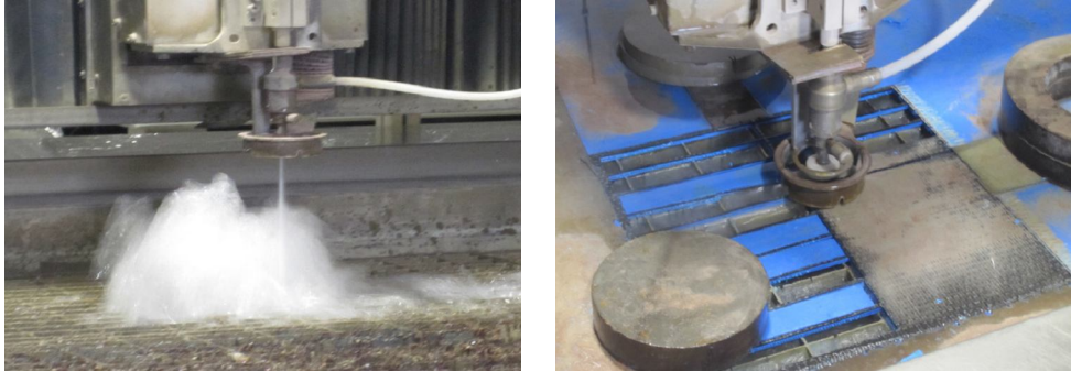
Figura 6.14 Fasi del taglio ad acqua dei provini di laminato composito
