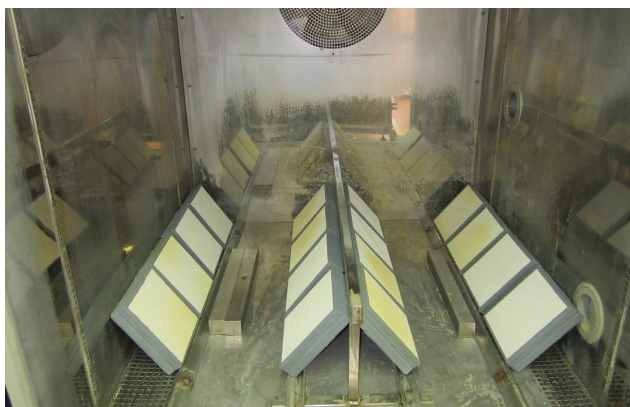
Figura 4.29 I campioni di pittura bianca ed ingiallita all'interno della camera climatica
