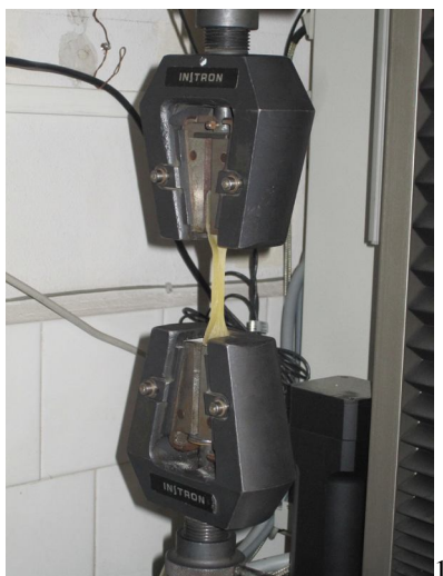
Figura 6.35 Un provino di resina (1) prima e (2) dopo la fine del test di trazione
