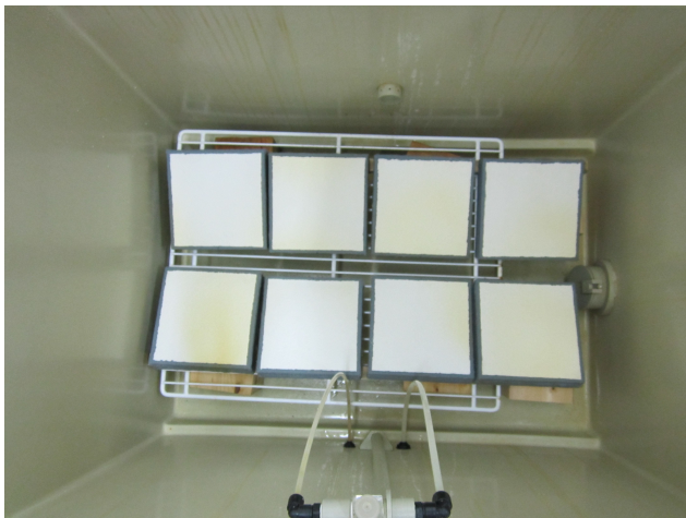
Figura 4.31 I provini disposti nella camera a nebbie saline
