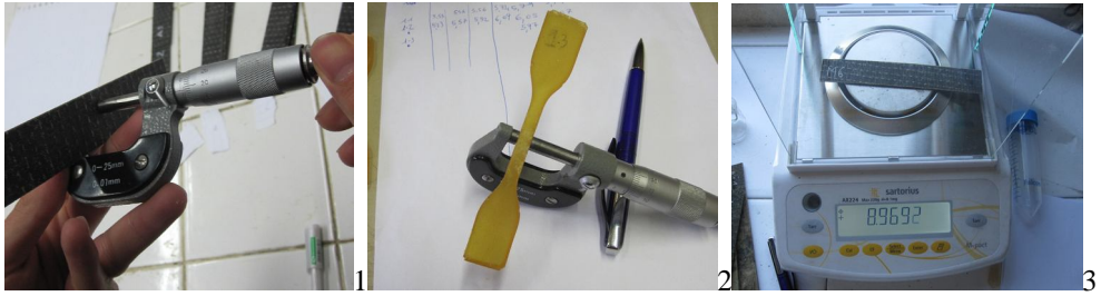
Figura 6.18 (1 e 2) Fasi di misura con micrometro e (3) bilancia elettronica dei provini
