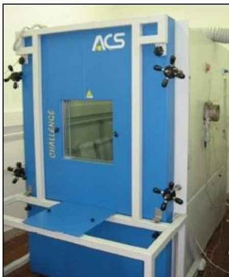
Figura 3.2 La camera climatica in dotazione al laboratorio di Edilizia
