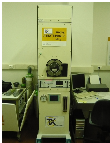
Figura 4.8 La strumentazione per la prova di abbattimento NO x nei laboratori Italcementi
