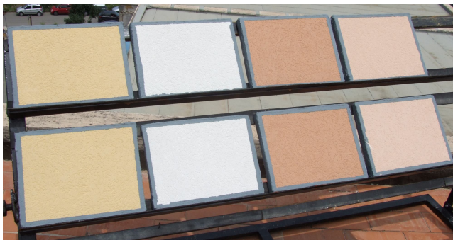
Figura 5.19 I provini nelle quattro tinte diverse, esposti all'atmosfera urbana
