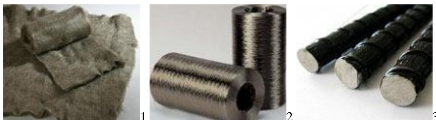
Figura 6.2 Forme diverse di basalto: (1) lana, (2) fabric, (3) tondini ( www.basaltnet.it )
