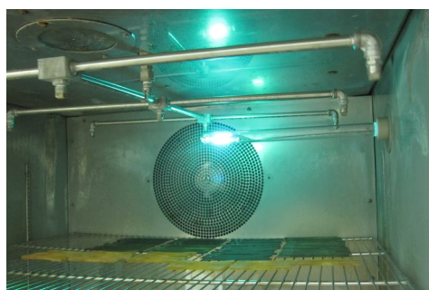
Figura 6.21 Disposizione dei provini per la fase B a 25 cm dalla lampada UV
