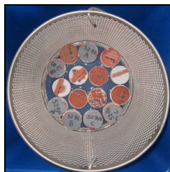
Figura 5.69 Fase di immersione dei campioni in acqua
