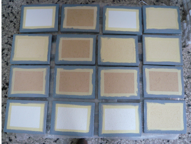
Figura 4.23 I campioni durante la fase di indurimento dello strato di impermeabilizzazione Complessivamente sono stati oggetto della ricerca n. 36 campioni di prova, di cui n. 24 disposti in camera climatica e n. 12 da disporre in esterno (Fig. 4.24).
