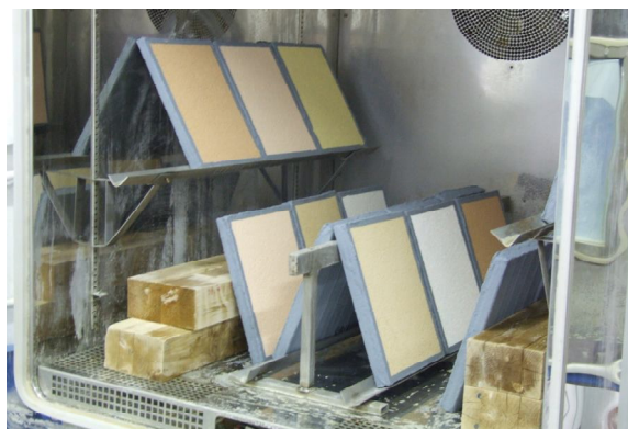
Figura 5.21 I provini disposti nella camera climatica per la fase A
