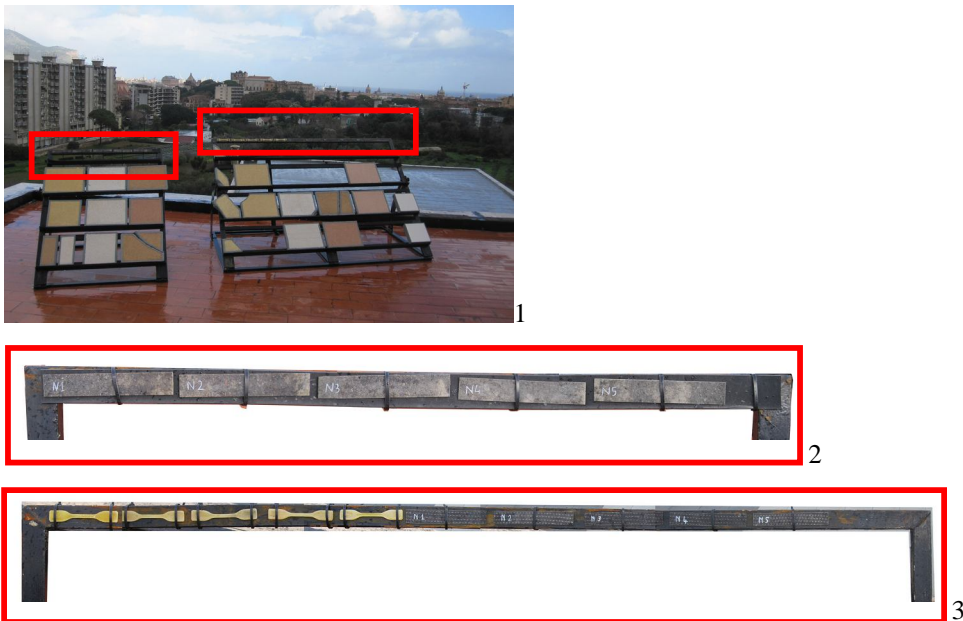
Figura 6.19 (1) Le griglie metalliche di supporto per l'esposizione agli agenti atmosferici dei provini, (2) dettaglio dei provini ibridi e (3) dei provini unidirezionali e di resina
