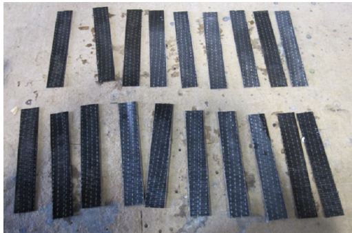
Figura 6.15 I provini ottenuti dal pannello laminato composito unidirezionale
