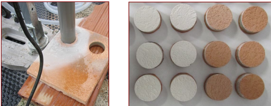
Figura 5.68 Carotaggio ed estrazione dei provini cilindrici
