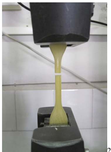
Figura 6.35 Un provino di resina (1) prima e (2) dopo la fine del test di trazione
