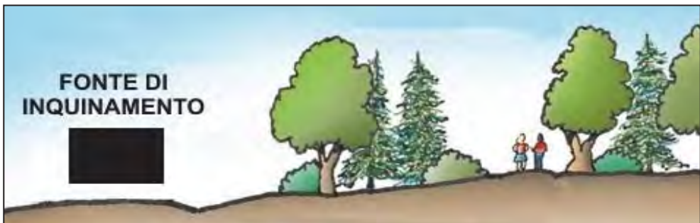
Fig. 12 Schema semplificato di un sistema verde per l'inserimento di una via pedonale in un'area ad alto inquinamento atmosferico. Il passaggio pedonale dovrebbe essere isolato dalla fonte di inquinamento da una fascia larga almeno 20 m (da BENTRUP, 2008; modificato).
