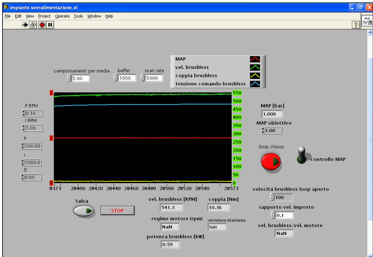
Figura 7.22 - Interfaccia grafica del VI di controllo del sistema di sovralimentazione. È possibile notare come con l'intervento su due switch si possa passare da controllo regime a controllo MAP e da loop chiuso a loop aperto.
