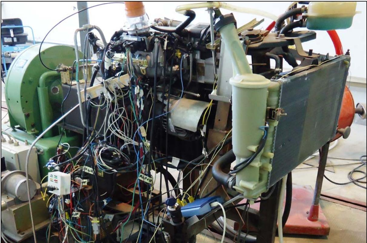
**Figura 7.14 - Motore Fiat F4P *bi-fuel*, installato nel banco prova motori.**
