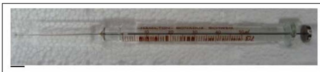
Figura 5.2 - Siringa di precisione con intervallo di misura compreso tra 0-0.05ml usata per il piombo tetraetile.
