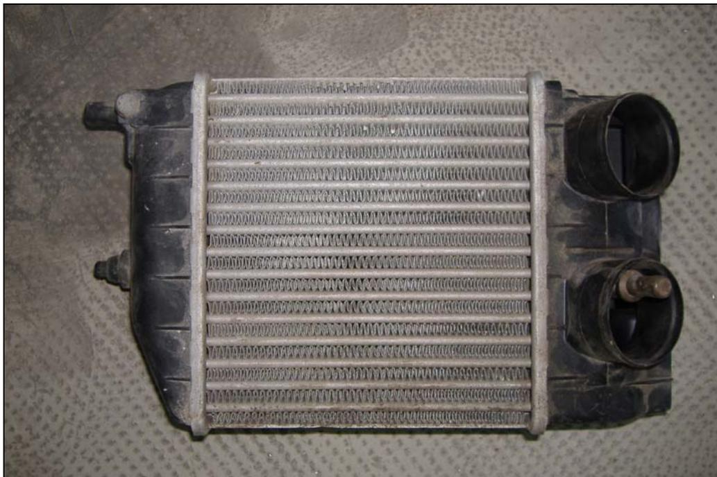
**Figura 7.12 – Interrefrigeratore impiegato per l'impianto di sovralimentazione.**
