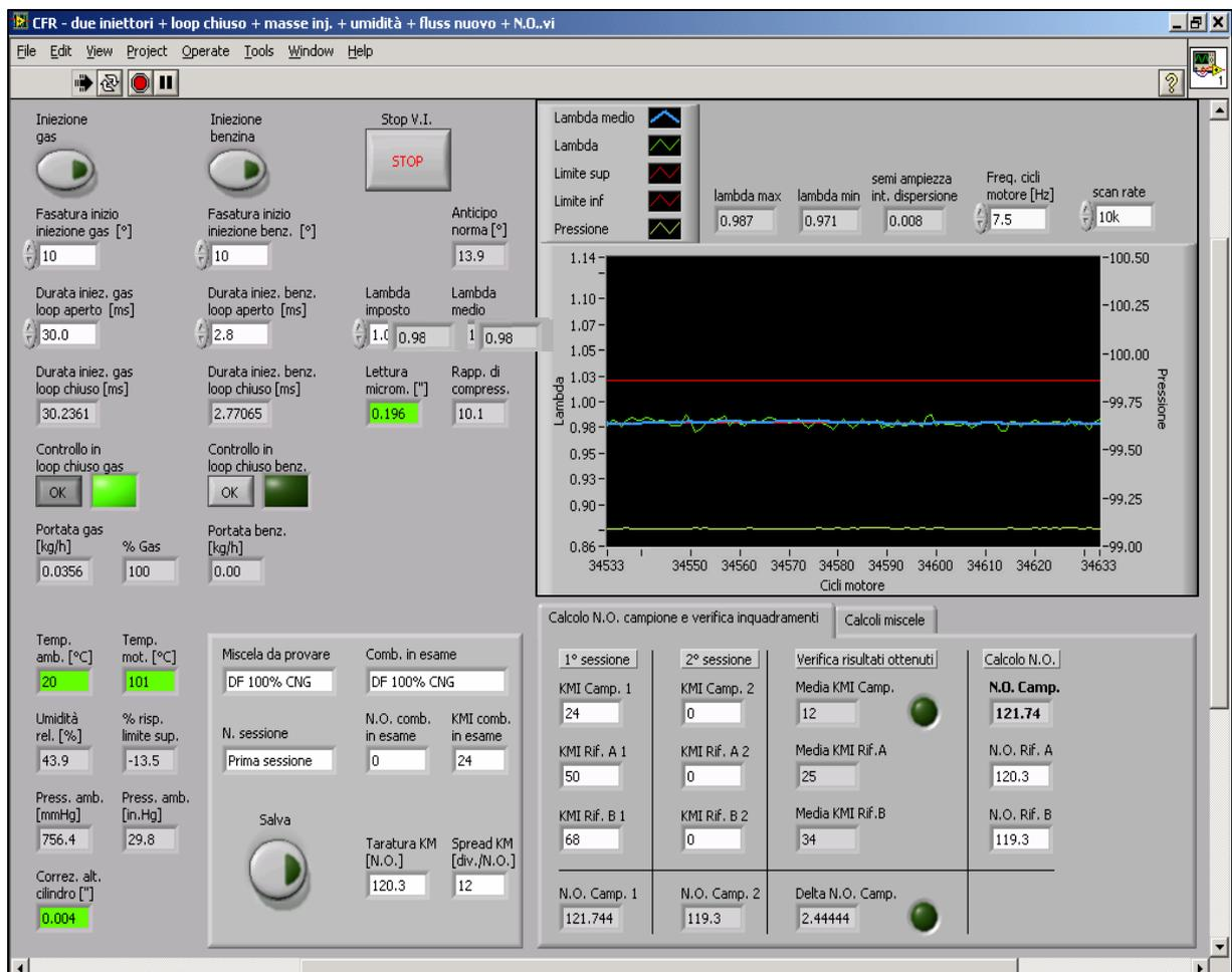
Figura 3.17 - Il front panel del programma sviluppato per il controllo del motore CFR.
