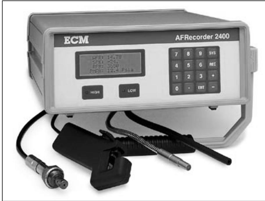
**Figura 7.18 - AFRecorder 2400 ECM con i suoi sensori: sonda UEGO, pinza amperometrica accensione, pickup regime motore e sensore MAP.**
