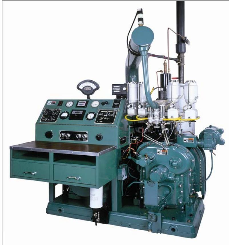
**Figura 3.5 – Vista di insieme di un motore CFR.**
