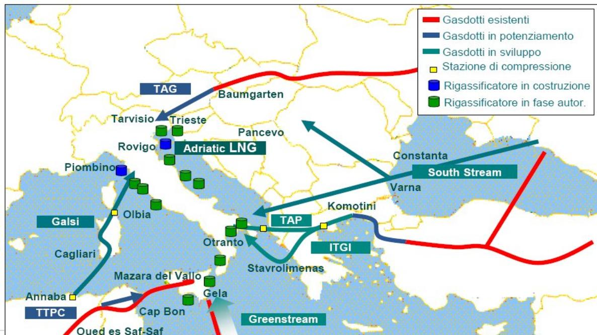
**Figura 2.6 – Schema della rete italiana di approvvigionamento di gas naturale.**
