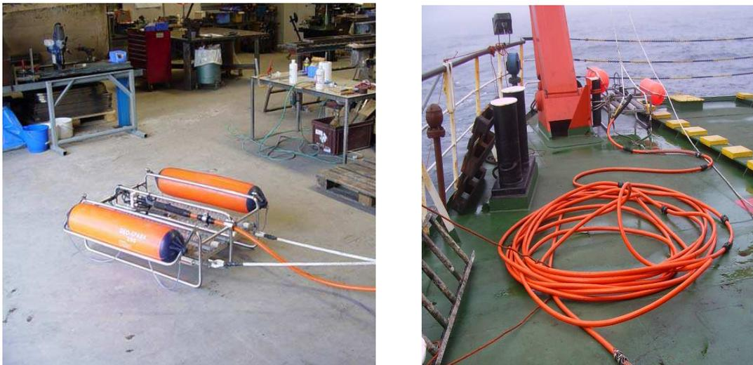
**Figura 7.4** – La figura mostra la sorgente Sparker ed il cavo (streamer) che contiene gli idrofoni.
