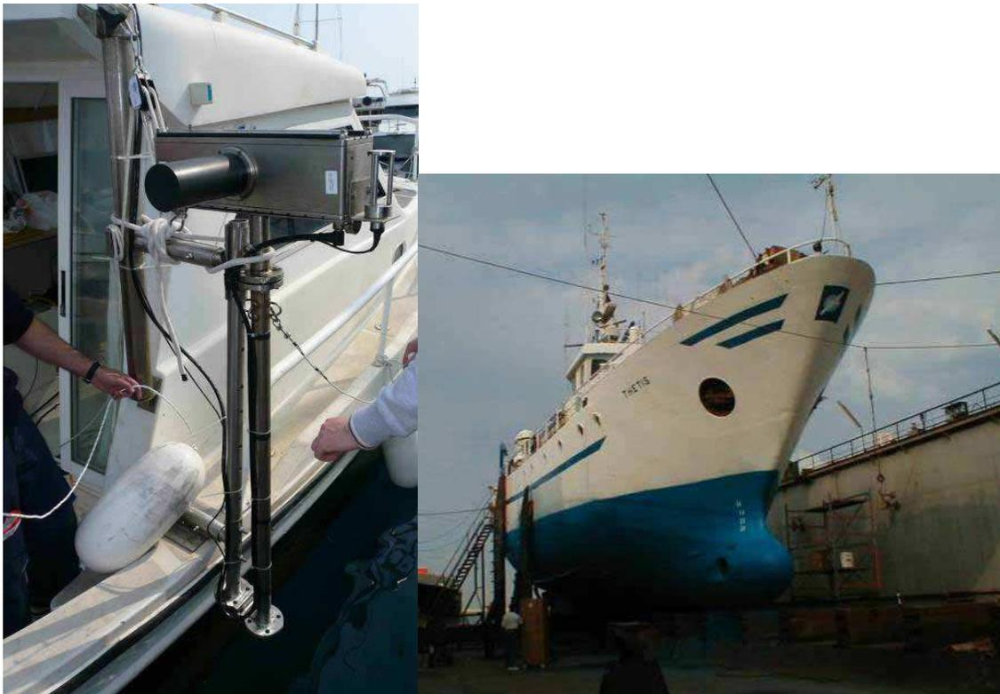
**Figura 7.6** – L'immagine a sinistra mostra il trasduttore montato su un palo nella parte laterale dell'imbarcazione; l'immagine a destra mostra il trasduttore posto sotto la chiglia dell'imbarcazione.
