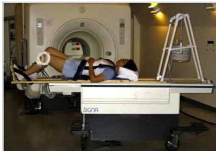
In particolare, questo sistema, non ferro-magnetico, ricorda quelli usati in palestra per sollevare i pesi con l'uso delle gambe, ed inoltre il peso complessivo del sistema così configurato risultava essere del 25% di quello del paziente esaminato, in quanto diversi studi precedentemente pubblicati hanno dimostrato che tale percentuale risulta sufficiente ad indurre una
