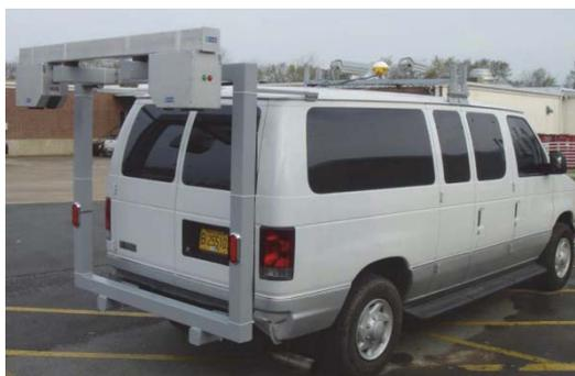
Figura 4.5– Il sistema LRIS della seconda fase (Wanget *al.*, 2007)
