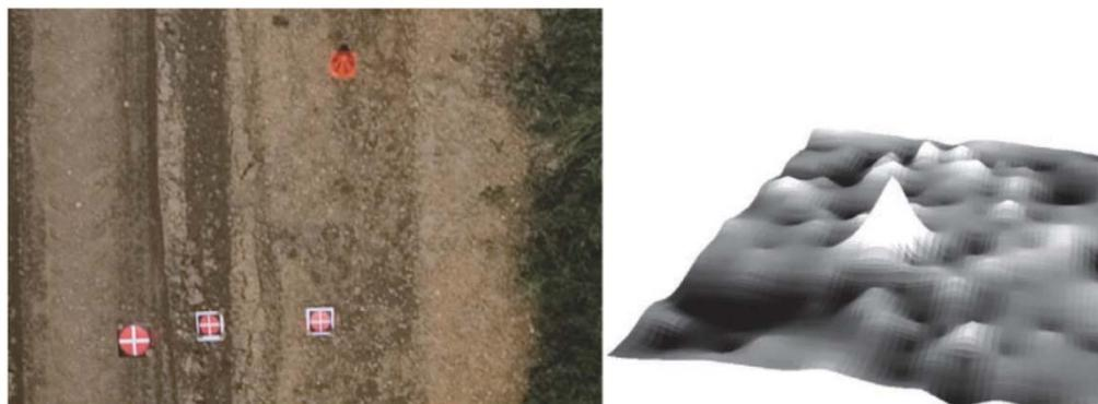
Figura 4.13– I coni e i segnali utilizzati per le verifiche metriche e la ricostruzione 3D di un cono di traffico.
