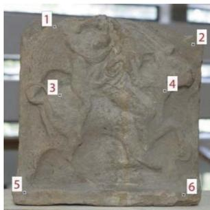
Figura 5.22 – Indicazione dei *target* fotografometrici utilizzati per le verifiche metriche
