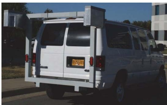
Figura 4.7– Il sistema DHDV con il sistema ibrido di *imaging laser 2D/3D* denominato *PaveVision3D*
