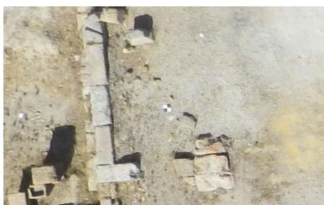
Figura 6.21 – *Target* utilizzati per il rilievo
