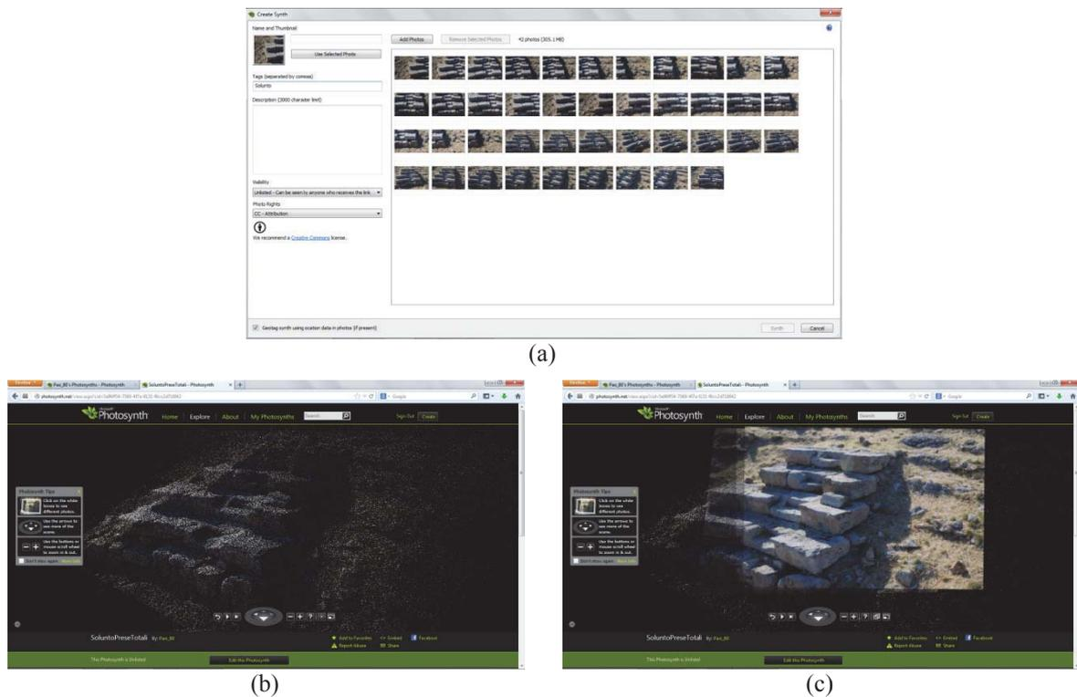
Figura 3.6 – Alcune schermate del 3D *web-service* Photosynth: (a) la piattaforma per il caricamento delle immagini con Photosynth e i synth creati (b) con le nuvole di punti e (c) con le foto
