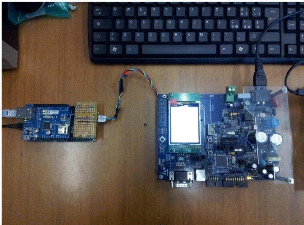
Fig. 90 Particolare del sistema di misura: scheda di interfaccia ethernet e concentratore, da installare in cabina secondaria per la gestione dei dispositivi di interfaccia via power line
