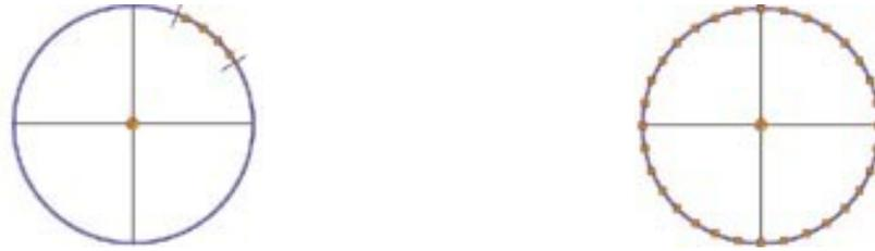
*Fig. 11 La CZT, effettuando un ingrandimento della FFT, utilizza soltanto una porzione del cerchio goniometrico (fig. a sinistra), mentre la FFT (fig. a destra) prevede l'impiego dell'intero cerchio*
