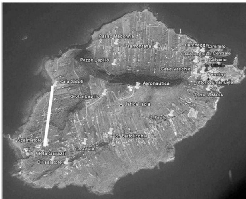
*Fig. 98 Immagine dell'isola di Ustica in Sicilia, Italia. Percorso dei cavi di media tensione connessi a due cabine secondarie Sidoti e Spalmatore, che si possono apprezzare in figura.*
