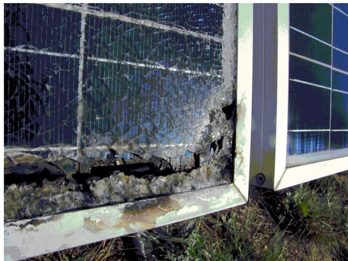
*Fig. 14 Pannello danneggiato da earth fault*
