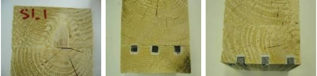
Figura 13. Campione senza rinforzo e con rinforzo in basalto dopo la prova Bmed
