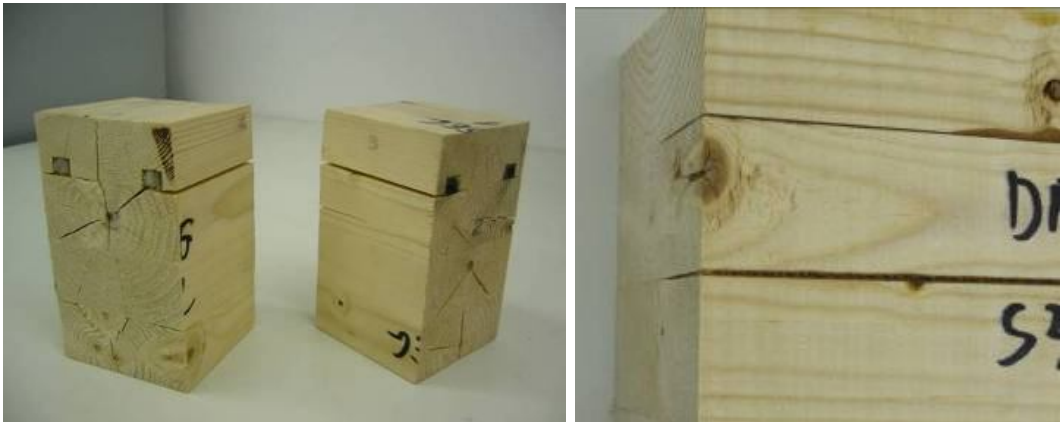
Figura 5. Trave rinforzata con fibre di vetro e carbonio applicate con resina epossidica e trave senza rinforzo incollata con adesivo epossidico.
