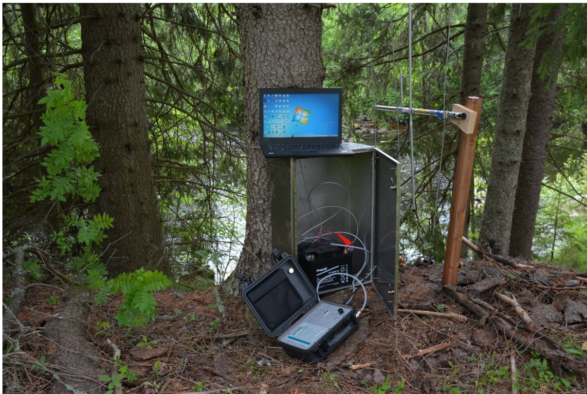
Kuva 9. Heikkilänjoen automaattinen radiovastaanotin ja 4-elementtinen Yagi-antenni. Etäyh-teydettömien radiovastaanottimien tiedot piti noutaa säännöllisin väliajoin maastosta. Kuva: Panu Orell.
