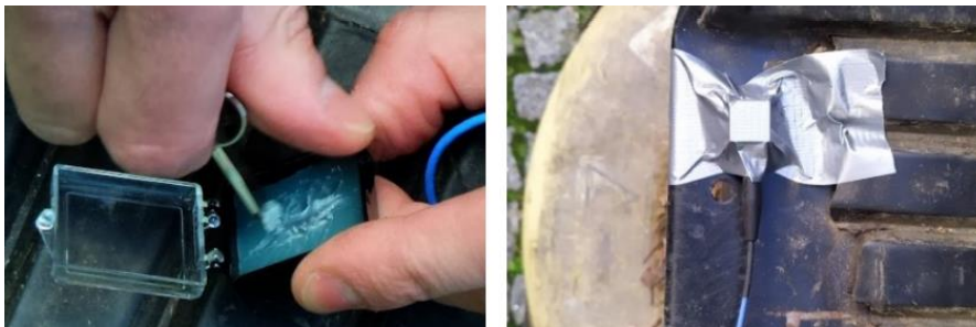
Figura 4 – Montagem do acelerómetro do pé.
