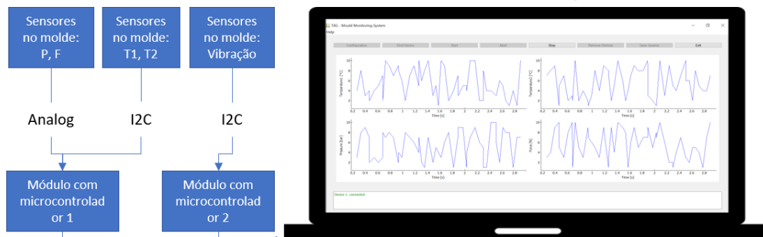
Fig. 1 – Representação esquemática do sistema de aquisição de baixo custo em desenvolvimento. A imagem central corresponde à IU desenvolvida.
