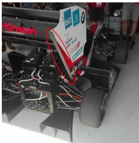
Figura 1 - Gurney flap na endplate de um carro FS.
