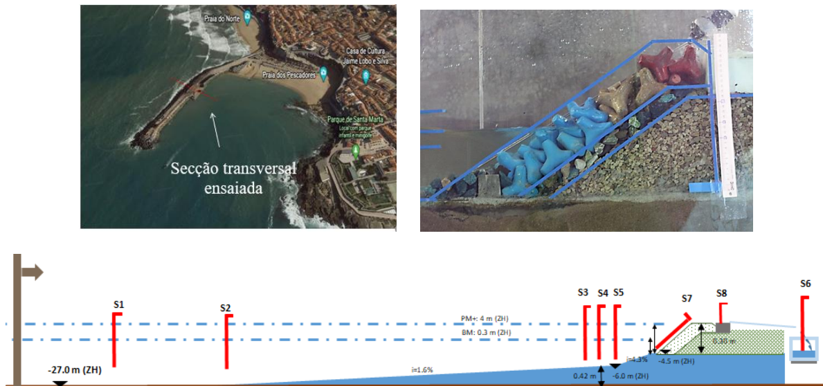
Fig. 1 – Porto da Ericeira: a) Secção transversal ensaiada; b) Implantação do modelo no canal e características do perfil transversal ensaiado
