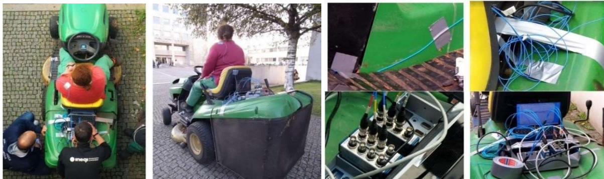
Fig. 1 – Montagem dos acelerómetros e sistema de aquisição de dados no trator para o teste.
