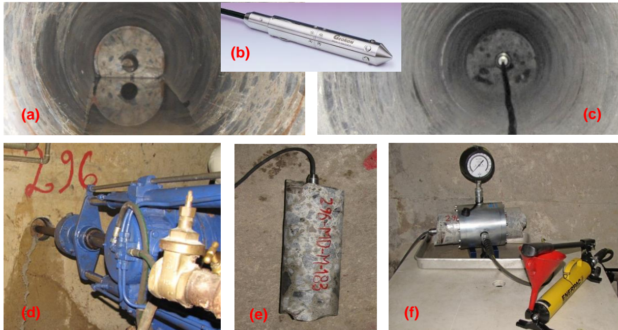
Fig. 2 – Ensaio de sobrecarotagem: (a) furos largo e estreito; (b) aparelho; (c) aparelho no furo estreito; (d) sobrecarotagem; (e) tarolo extraído com o aparelho; (f) ensaio biaxial
