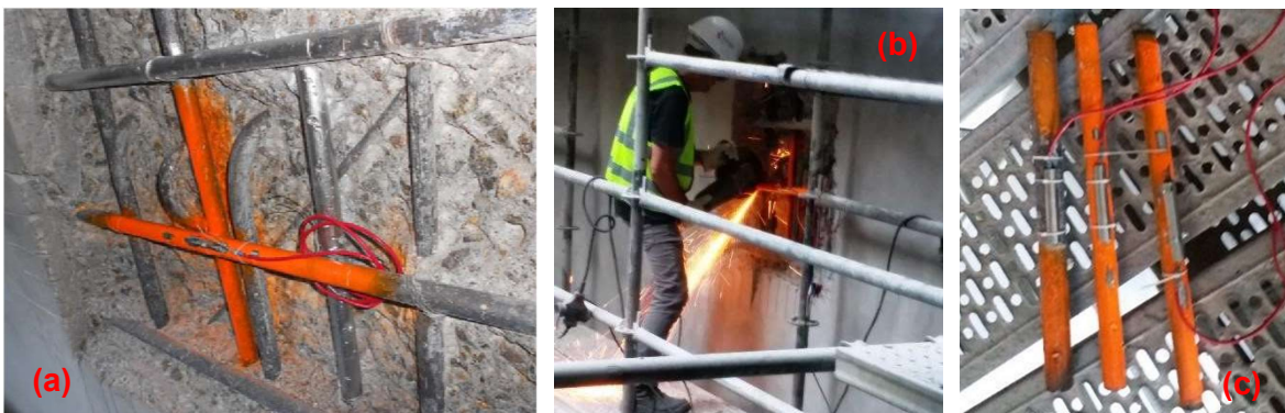
Fig. 2 – Aspetos dos ensaios “in situ”: a) varões instrumentados, b) operação de corte dos varões e c) amostras recolhidas para ensaio no LNEC
