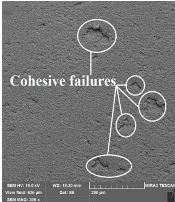
شکل ۳) تصویر میکروسکوپ الکترونی از مقطع شکست کامپوزیت- فولاد با چسب متاکریلات (مناطق نشان داده شده: نواحی شکست پیوستگی)
