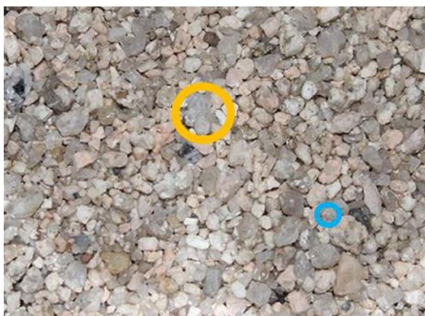
図3 モード分析に用いた真砂土
