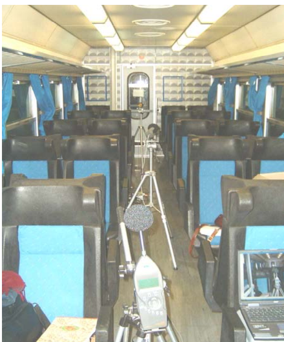
Figura 4 – Disposizione degli strumenti all'interno del vagone
