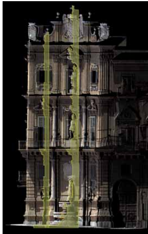
Fig. 7. Facciata settentrionale (canto di Santa Oliva), vista della nuvola di punti e di due sezioni verticali.
