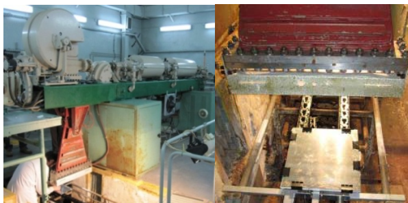
Figura 2: a) profili termici misurati durante il processo di irraggiamento; b) immagini dell'acceleratore di elettroni e dello stampo posizionato su una slitta sotto il pennello che lancia il fascio di elettroni. Lo stampo passa più volte sotto il fascio attraverso un moto alterno della slitta.
