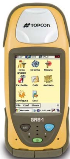
Figura 3 - Ricevitore GRS-1 della Topcon utilizzato
