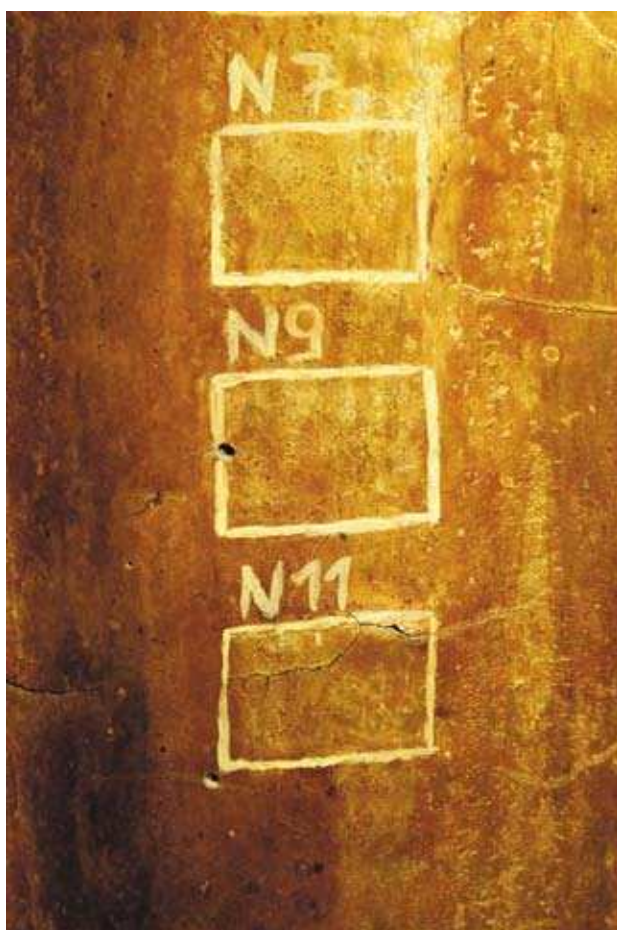
Figg. 23 a, b - Prove di solubilità, mediante test di Feller. Luce visibile e Ultravioletta.
