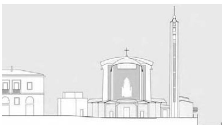
Fig. 7. Il complesso di Santa Maria, progetto di restauro, prospetto principale con il nuovo battistero
