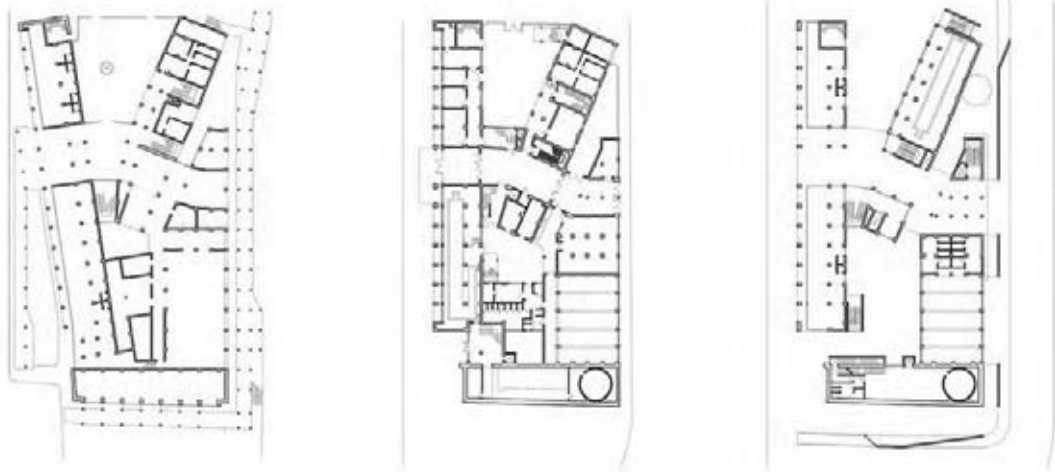
Fig. 8. Istituto Nautico, progetto di restauro, pianoterra, confronto fra progetto del 1949, rilievo dello stato di fatto e progetto di restauro
