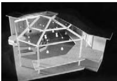
Fig. 15. HAEFELI, MOSER, STEIGER, Chiesa neoapostolica, Ginevra 1947-50. Modello dello spazio interno che restituisce l'impianto d'illuminazione d'origine, con lampade sospese a dei cavi, a diverse altezze. Proposta di reintegrazione dell'architetto designer Marie-Dina Salvione Deschamps
