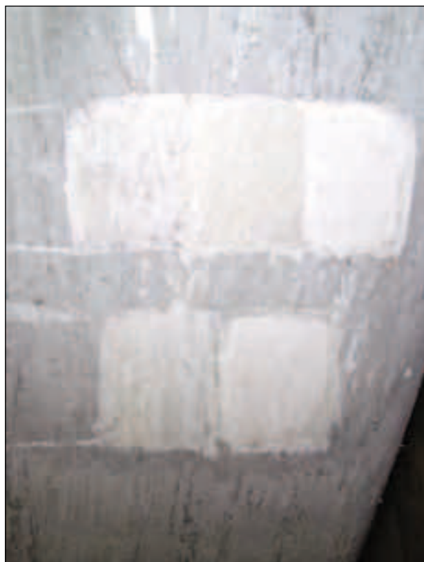
Fig. 40 – Giacomo Serpotta, Cappella di San Girolamo , 1696, chiesa di Sant'Orsola, Palermo, particolare di un angelo che mostra la stratigrafia delle scialbature riscontrate sulla materia originale.
