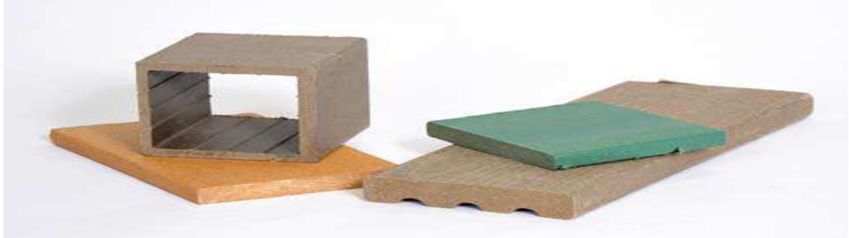
Şekil 2. Çeşitli renklerde ve şekillerde odun plastik kompozitler (Taylor A. Et al, 2010).
