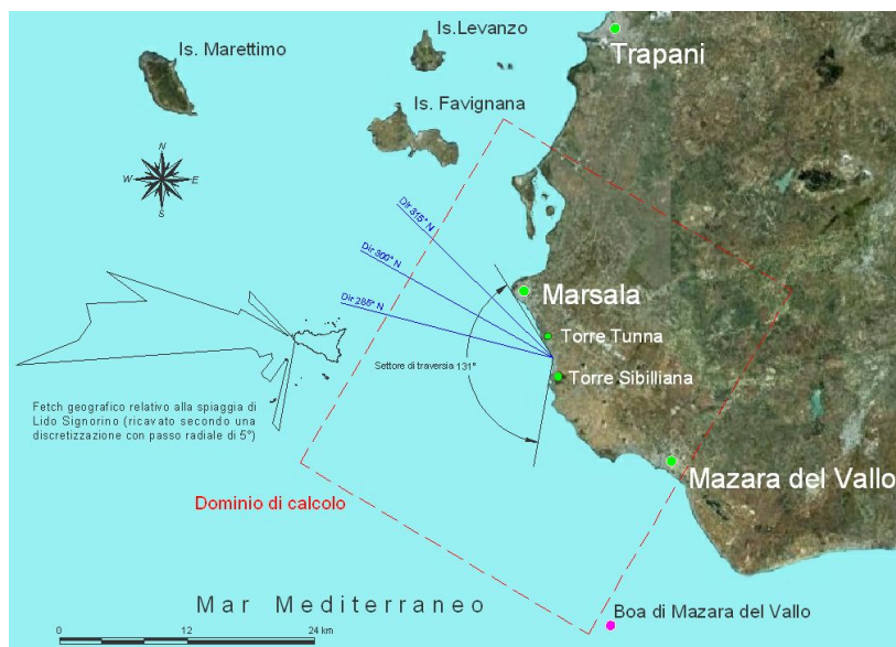
Figura 1. Ubicazione geografica del tratto di costa d'interesse con segnato il settore di traversia, il dominio di calcolo e le direzioni del moto ondoso più critiche. Tratteggiato in rosso il dominio di calcolo.
