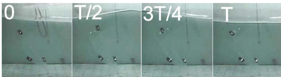
Figura 6. Spostamento degli apici delle foglie di una pianta artificiale di Posidonia Oceanica durante un periodo di oscillazione. Particolare della tecnica utilizzata per individuarne la posizione.
