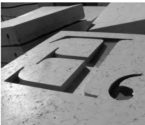
La somiglianza tra la costruzione e la sua rovina (G.B. Piranesi, L'antichità d'Albano e di Castelfidardo). I blocchi della costruzione sono realizzati in massello di Pietra di Lessinia, depositati in cantiere.
