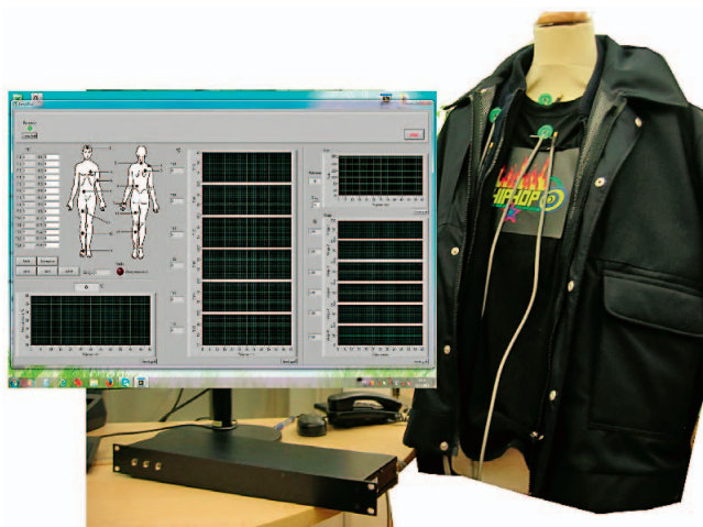
Sl.5 Uređaj za mjerenje fizioloških parametara ljudskog tijela pri egzaktom vrednovanju toplinske udobnosti odjeće
