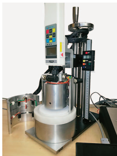
Sl.6 Višenamjenski diferencijalni konduktometar za tekstilne kompozite i odjeću
