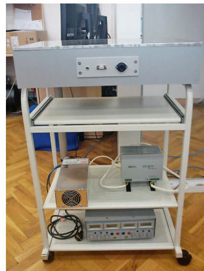
Sl.2 Mjerni sustav za određivanje toplinskih svojstava kompozita
