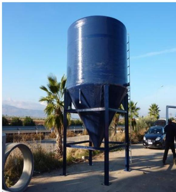
Figura 19 Espesador por gravedad estático
