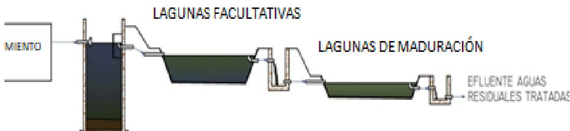
Figura 13 Tratamiento por lagunaje con lagunas anaerobias, facultativas y de maduración
